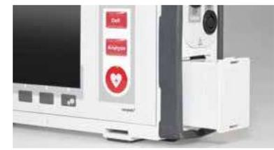
La potente batería de Li-Ion proporciona al **corpuls1** la energía necesaria para una duración extremadamente larga e incluso a -20°C. En la pantalla se muestra en todo momento el tiempo de uso restante en minutos o el porcentaje.
