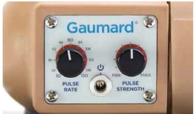
Un sistema arterial controlado por microbomba permite que la frecuencia e intensidad del pulso sean variables.
